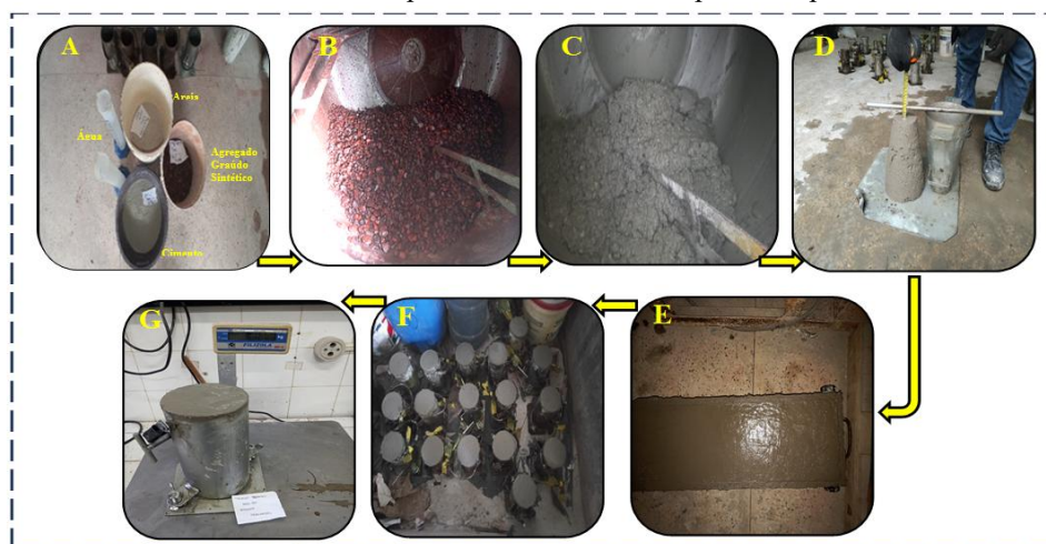
Figura 6 - Sequenciamento da dosagem e moldagem. A) Materiais para dosagem; B e C) Misturas dos agregados na betoneira; D) ensaio de consistência do concreto; E) e F) Moldagem dos corpos de provas cilíndricos e prismáticos; G) detalhe do concreto para análise da massa específica aparente
