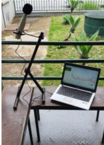
Figura 6 - Disposição dos equipamentos no local de medição
