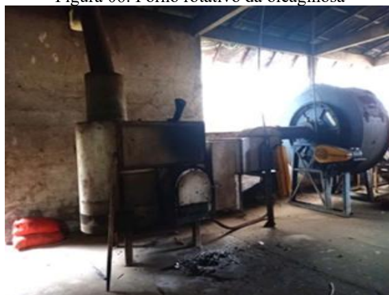
Figura 06: Forno rotativo da oleaginosa
