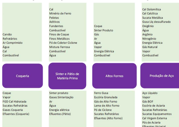
Figura 4. Diagrama de blocos Indústria Siderúrgica
